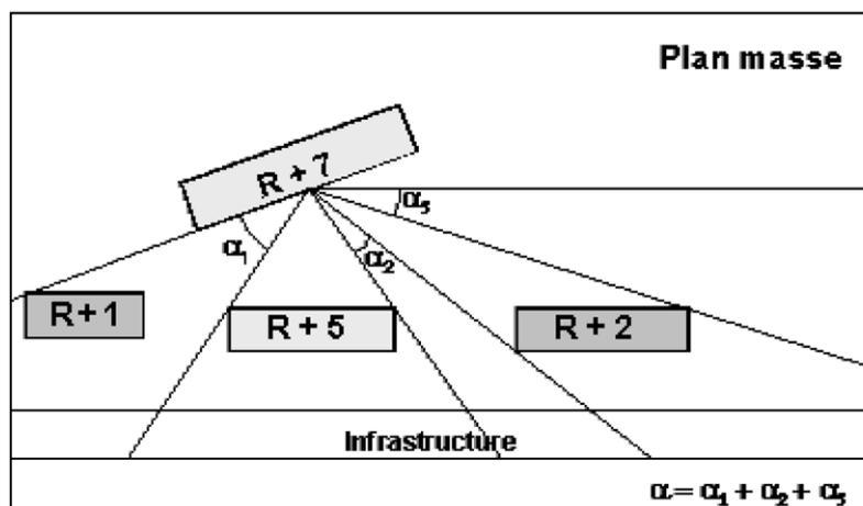
Angle de vue  $\alpha$  pour un point situé au 4<sup>e</sup>me étage au milieu de la façade du bâtiment R+7
