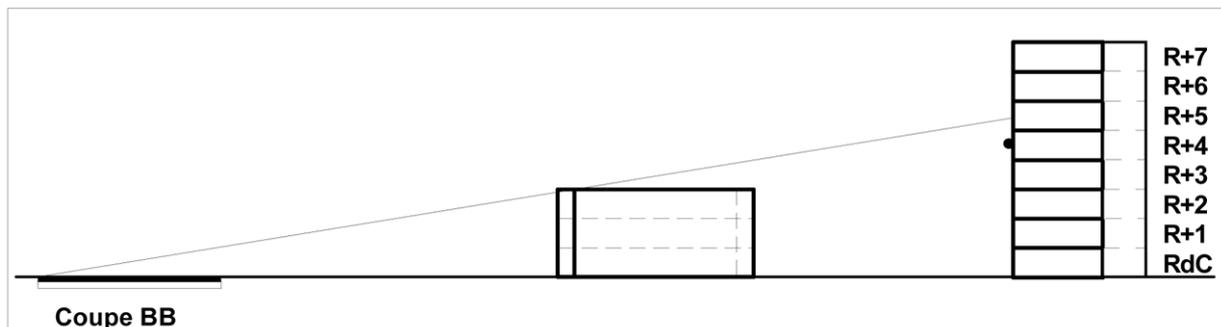
Exemples de coupes sur le bâtiment R + 2 : les coupes AA et BB permettent de déterminer les points sur la verticale passant par le point d'observation de la façade étudiée en dessous desquels l'infrastructure n'est pas en vue directe.
