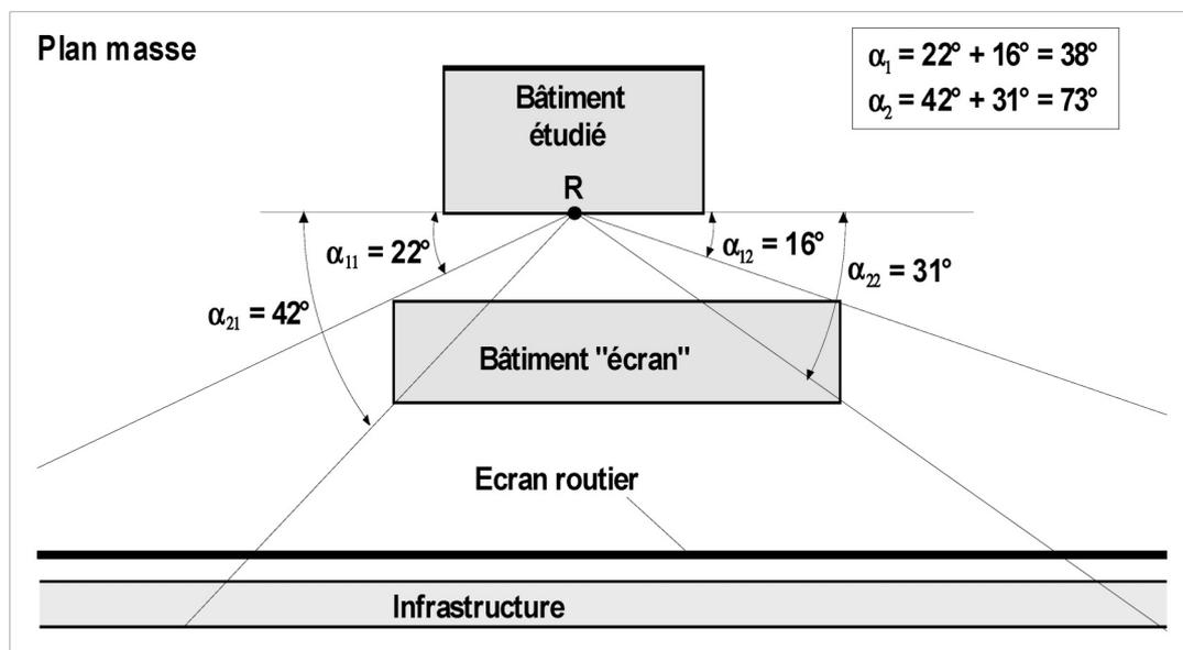
Dans l'exemple ci-dessus, la façade du bâtiment étudiée est protégée des bruits de l'infrastructure par un écran routier le long de l'infrastructure et par un bâtiment faisant écran. Pour la verticale passant par le point R de la façade étudiée, on détermine les angles  $\alpha$  sous lesquels l'infrastructure est encore vue (voir ci-dessus « protection des façades du bâtiment considéré par des bâtiments »).
