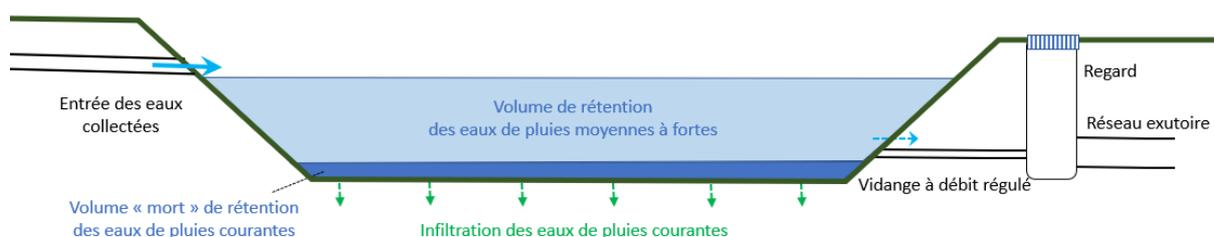
*Schéma de principe de gestion des pluies courantes dans un « volume mort » aménagé dans le dispositif de rétention-régulation des pluies moyennes à fortes*
